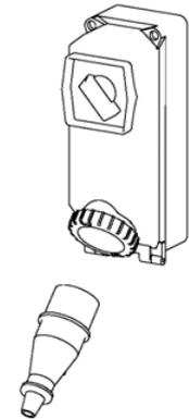
Fig. 6.2.1. - Dispositivo di sezionamento generale in posizione (O - OFF) Fig. 6.2.2. - Dispositivo di sezionamento generale disinserito
